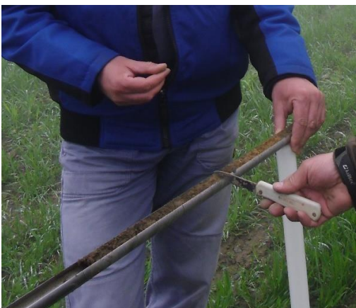
Abb. 1: Ansprache eines Bodenprofils am Bohrstock
