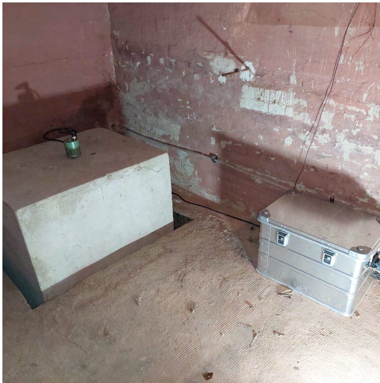
Abbildung 1.3: Seismometer auf dem Fundament der ehemaligen Station aus den 50er Jahren.
