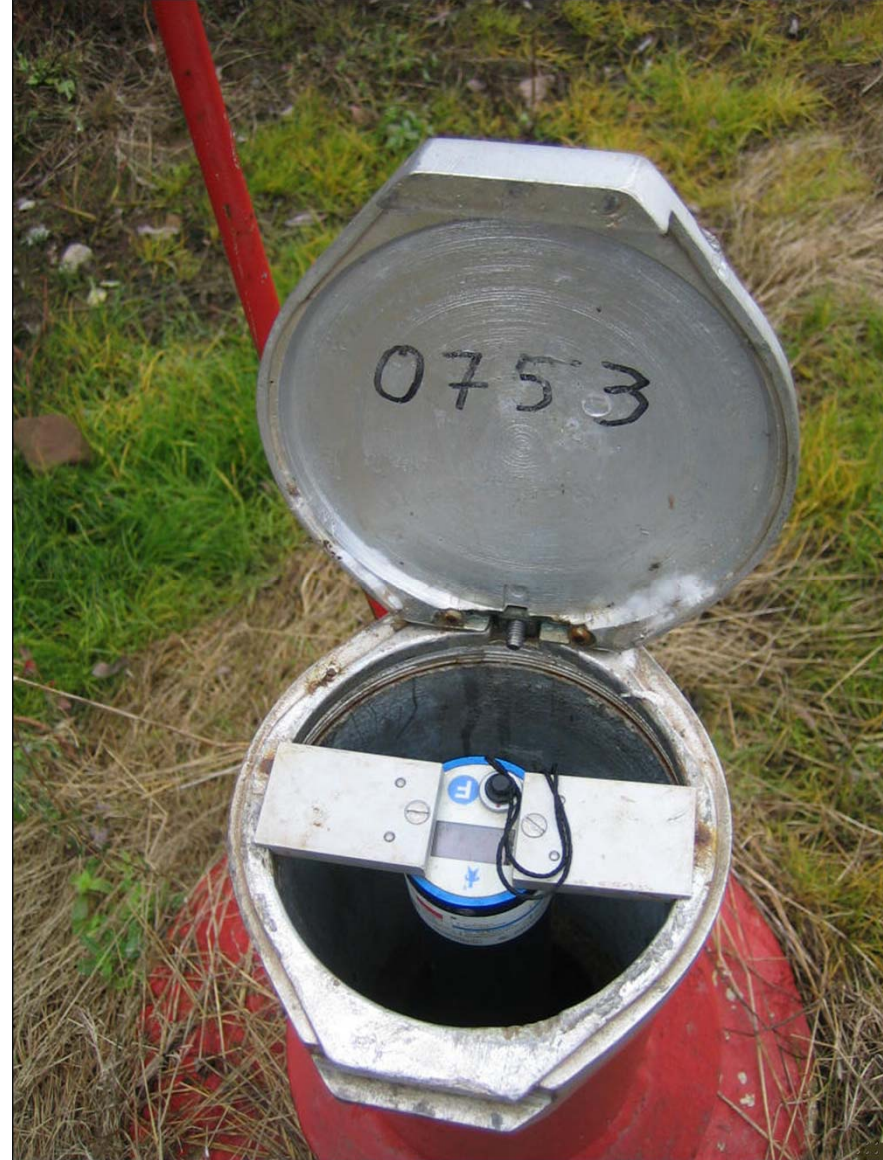
Die Grundwassermessstelle bei Heiligenstadt ist mit einem Datenlogger ausgerüstet und erfasst den Kluft-Grundwasserleiter „Mittlerer Buntsandstein“.
