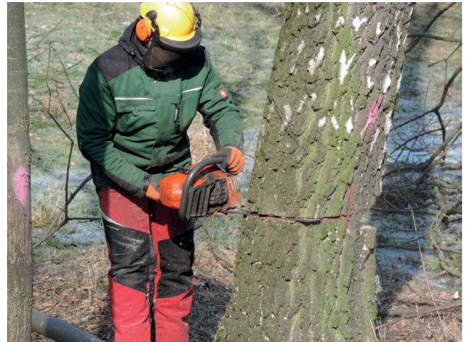
Foto 84: Der Fällschnitt wird nun entlang der Markierung geführt. (Foto: A. Stowasser)
