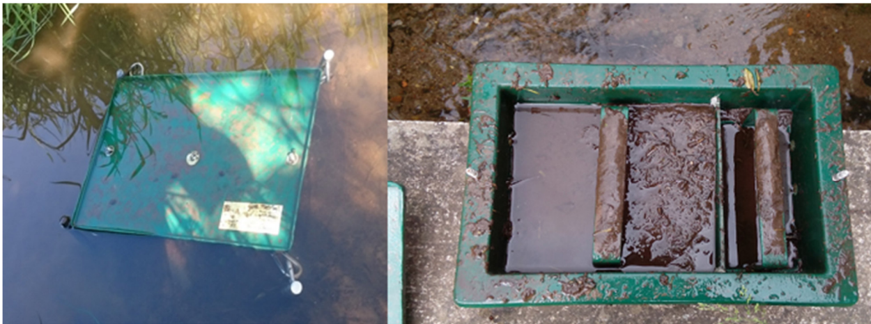
Eingebaute Schwebstofffalle im Gessenbach
