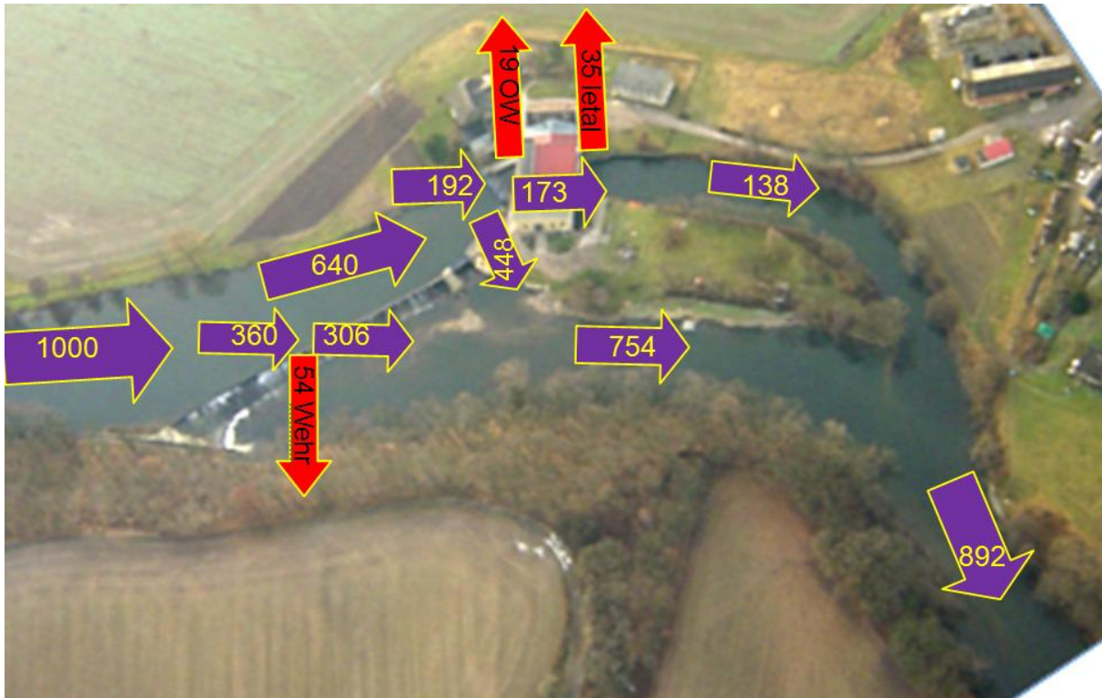
Abbildung 21: Beispiel verschiedener Abwanderwege und Ermittlung der Schädigungen abwandernder Lachssmolts an einem Standort mit WKA (Überlebensrate Standort); bildliche Darstellung am Beispiel des WKA-Standortes Döbritschen mit Zahlen des Planzustandes 1 (Aufn. Luftbild F. Fleischer)
